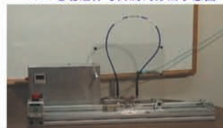
C04I电缆组件弯曲测试方法示意图
